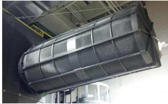
2. ábra – lángmentes lefűvató berendezéssel szerelt porleválasztó
