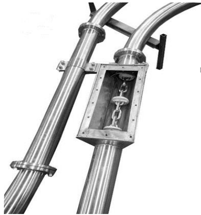
D.18. ábra – Csőláncos anyagmozgató rendszer belső kialakítása
