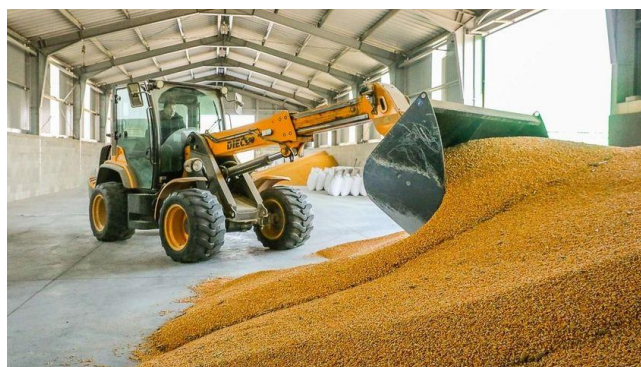
D.21. ábra – Síktárolóban anyagmozgatás markoló rakodó géppel
