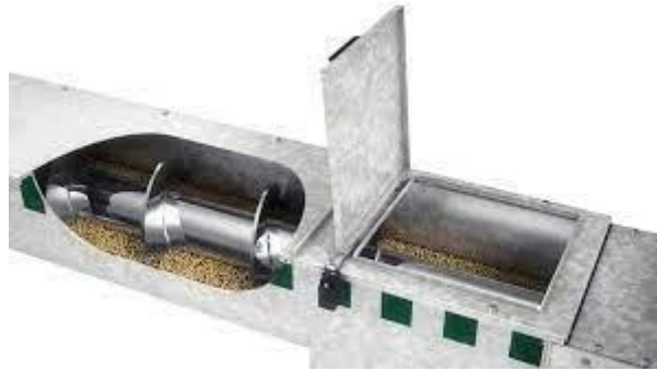
D.19. ábra – Szállítócsiga belső kialakítása
