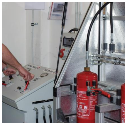
Tartályok nyomáspróbázása (a palástba beütött érték szerint)
