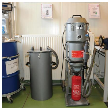
Porvisszatöltés zártrendszerű berendezéssel
