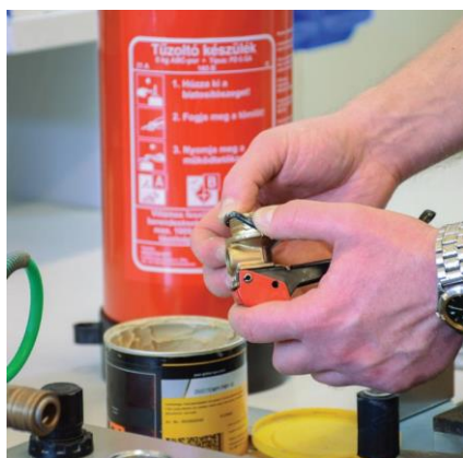
Új O-gyűrű felhelyezése minden karbantartáskor
