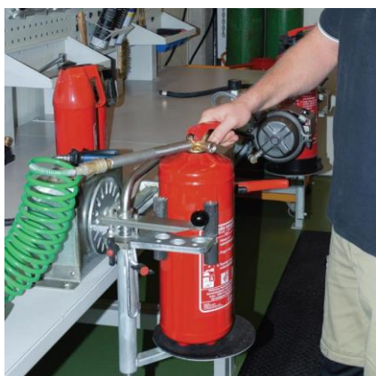
A készüléket nitrogénnel nyomás alá helyezzük
