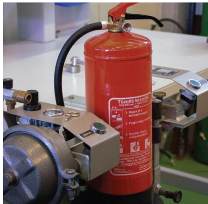
Készülék stabil rögzítése készülékbefogóval
