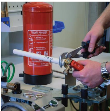
Felszállócső kitekerése a fejszerelvényből
