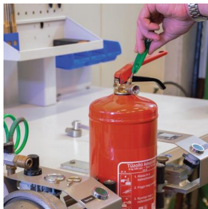
Készülék nyomásmentesítése a szelepbetét eltávolításával
