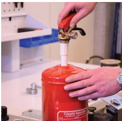
Komplett fejszerelvény függőleges behelyezése a tartályba
