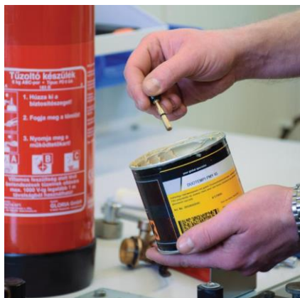
Szelepszár zsírozása, fejszerelvény összeszerelése
