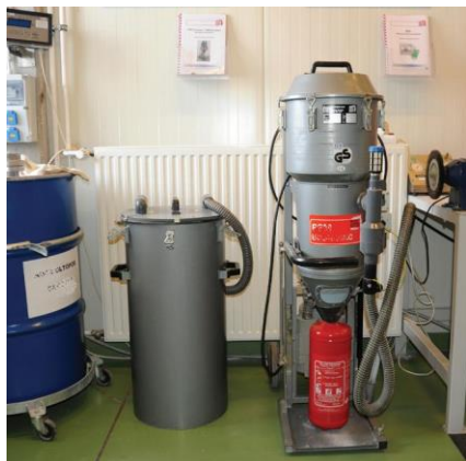
Porvisszatöltés zártrendszerű berendezéssel
