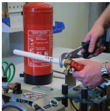
Felszállócső kitekerése a fejszerelvényből
