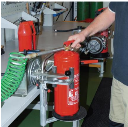
A készüléket nitrogénnel nyomás alá helyezzük
