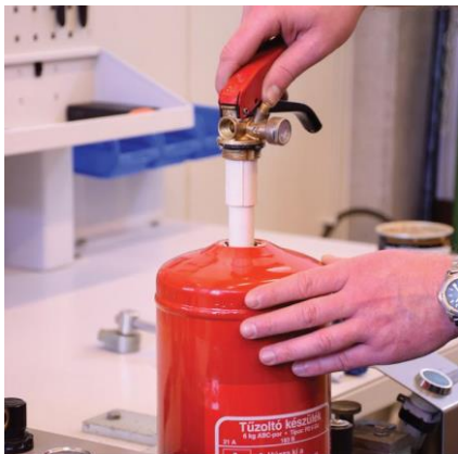
Komplett fejszerelvény függőleges behelyezése a tartályba
