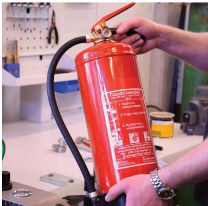
Karbantartott készülék végső szemrevételezése
