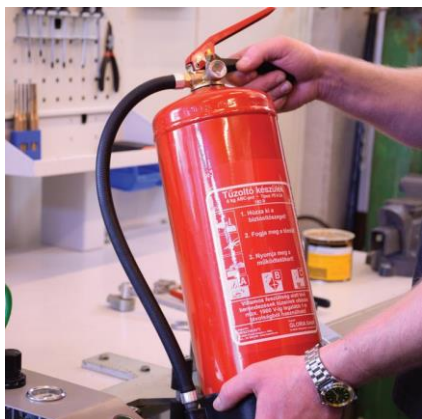
Karbantartott készülék végső szemrevételezése
