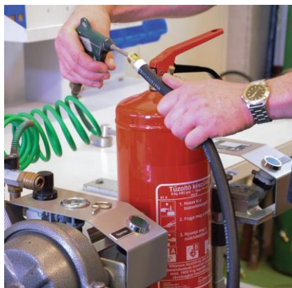
Tömlőszerelvény vizsgálata, kifűtatása sűrített levegővel
