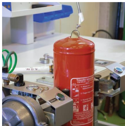
Tartály ellenőrzése tükrös tartályvizsgálóval
