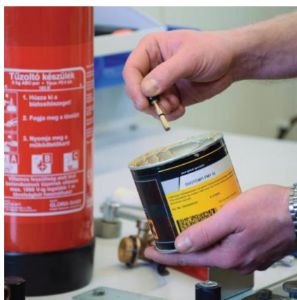
Szelepszár zsírozása, fejszerelvény összeszerelése
