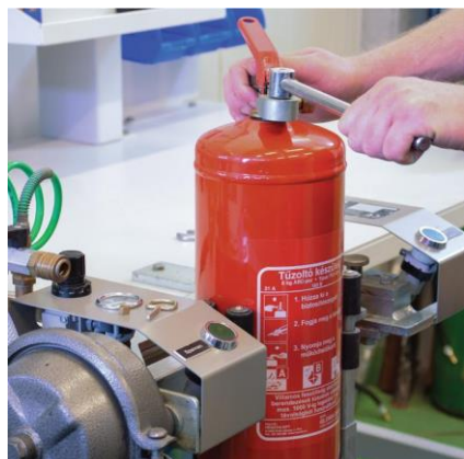
Fejszerelvény kitekerése CSAK NYOMÁSMENTES ÁLLAPOTBAN!
