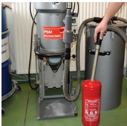
Porkiszívás zártrendszerű berendezéssel
