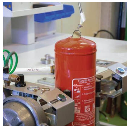
Tartály ellenőrzése tükrös tartályvizsgálóval
