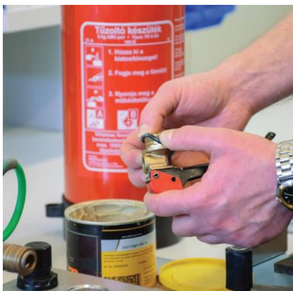
Új O-gyűrű felhelyezése minden karbantartáskor
