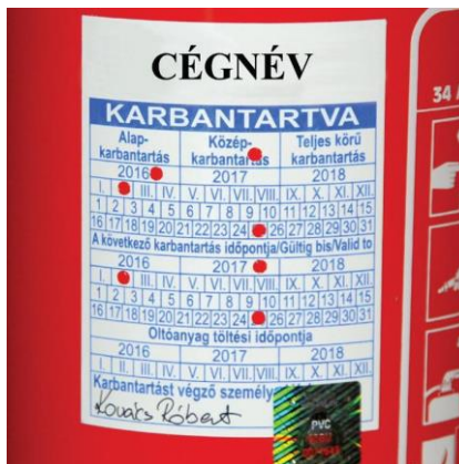
Karbantartást igazoló címke felhelyezése OKF azonosító jellel
