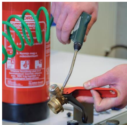
A fejszerelvény kifűvése sűrített levegővel
