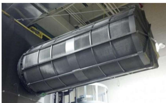
2. ábra – lángmentes lefűvató berendezéssel szerelt porleválasztó
