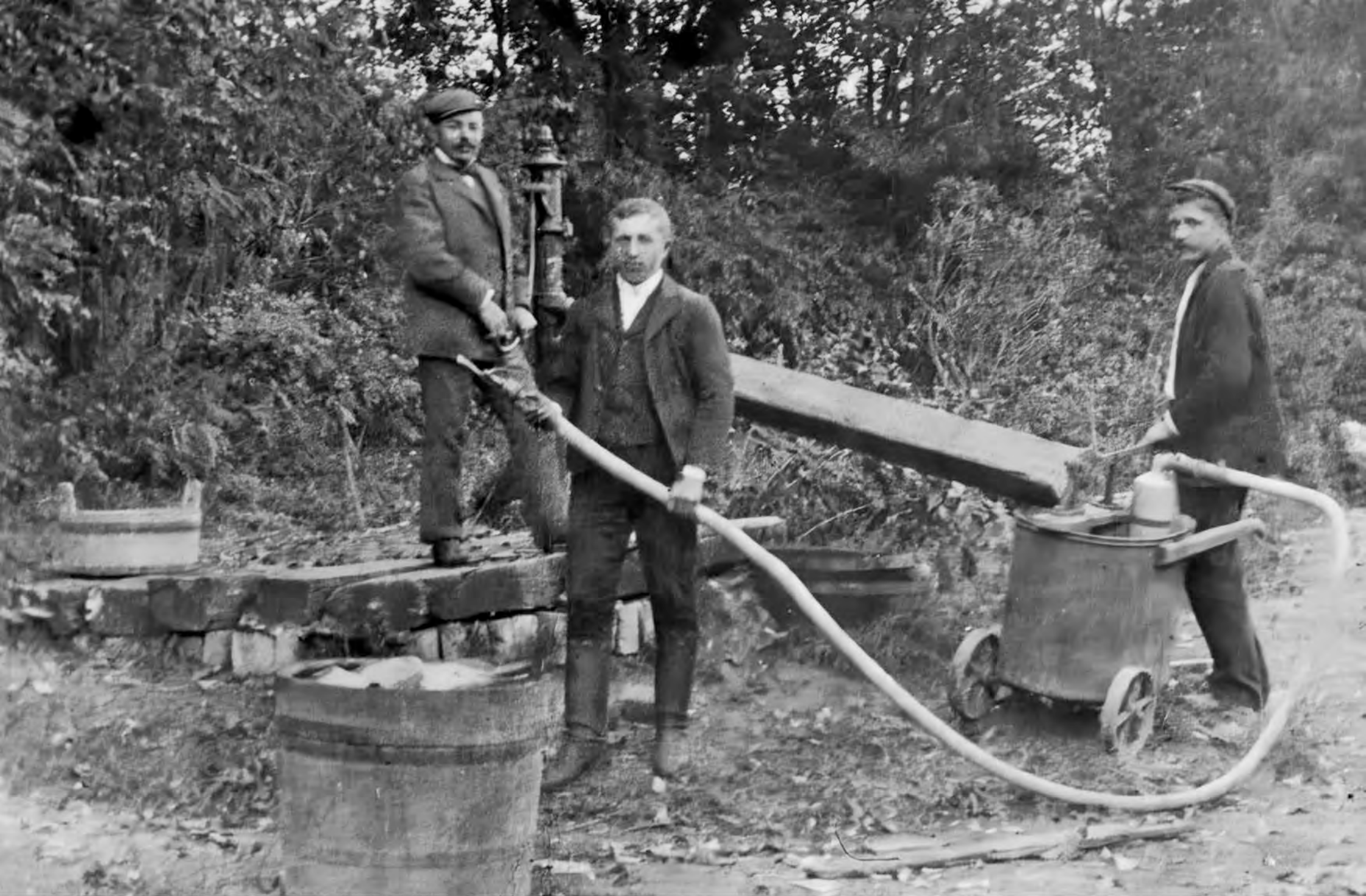
Nyomókútról töltött targoncafecskendő egy zalai gazdaságban. A tömlő végén lévő kisméretű állítható szórófejet elsősorban locsolásra használták.
